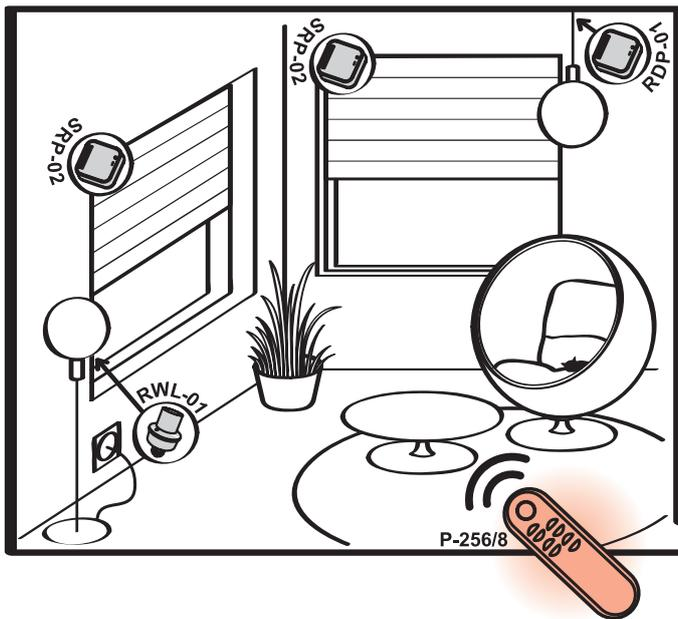
Пульт P-256/8 может работать с любым приемником системы EXTA FREE. В данной аппликации использован для управления рольставнями и освещением. Контроллеры рольставней SRP-02 могут управляться централизованно или независимо (локально), приемник RWL-01 принимает сигнал вкл/выкл, а диммер RDP-01 предоставляет возможность плавной регулировки интенсивности освещения.
